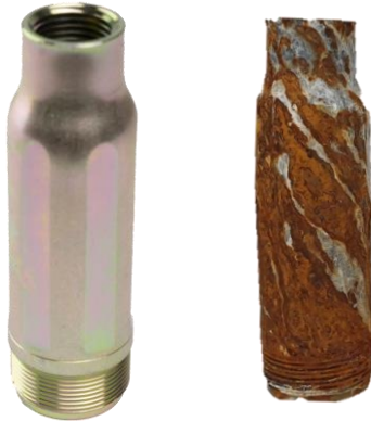
Hình 2.8. Reducer trước và sau khi xuất hiện gỉ sét (sau 240 giờ phun muối)
